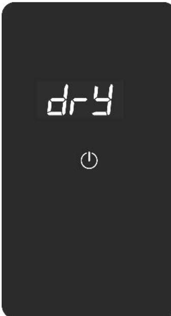
Abb. 20 „dry“ - Trocknungsprogramm läuft
