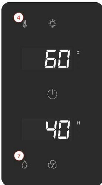
Abb. 12 Einschalten der Betriebsart „finnische Sauna“ oder „Dampfsauna“
