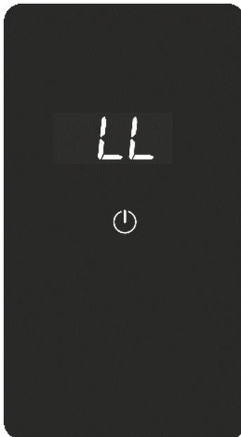
Abb. 24 „LL“ - die Temperatur eines der beiden Sensoren ist unter 0 °C
